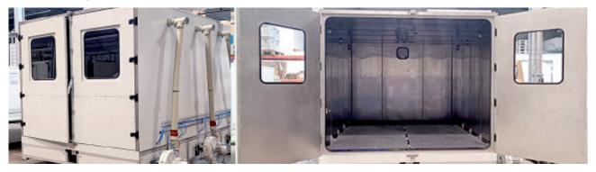
Zur Prüfung der zuverlässigen Funktion und des sicheren Gebrauchs eines Gerätes oder Bauteiles gehören u. a. die Dichtigkeitsprüfung und das Prüfen auf Eindringen von Fremdkörpern und Staub. Ebenso kann die Belastung verschiedener Geräte durch Staub simuliert werden. In vielen Standards sind Staubprüfungen verpflichtend und ein Baustein mehrerer Prüfungen, die ein Prüfling vor der Markteinführung bestehen muss.
