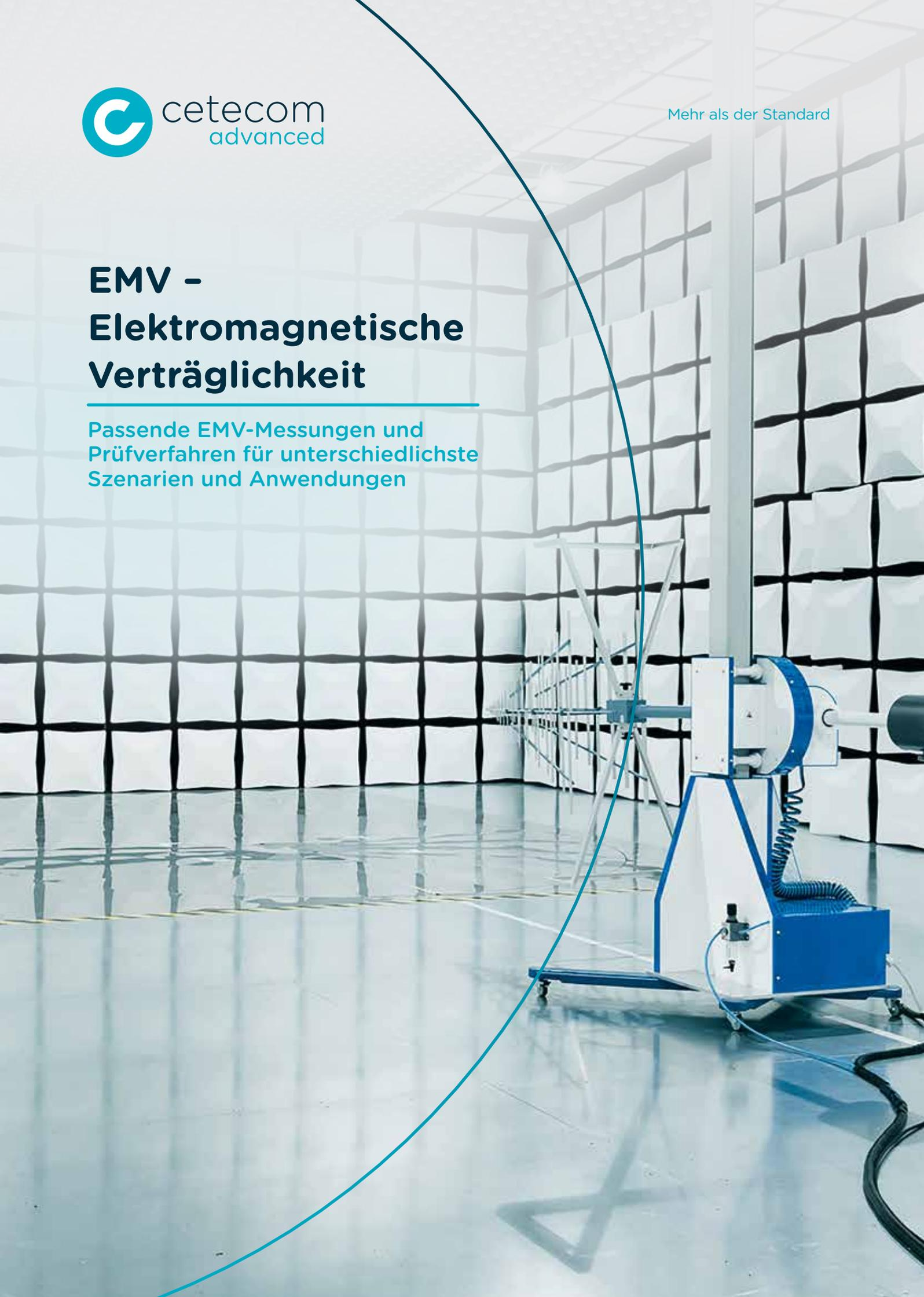
EMV bezeichnet die Fähigkeit eines elektronischen Geräts oder Systems, in seiner elektromagnetischen Umgebung fehlerfrei zu funktionieren, ohne unzulässige elektromagnetische Störungen zu verursachen oder durch solche Störungen beeinträchtigt zu werden.
